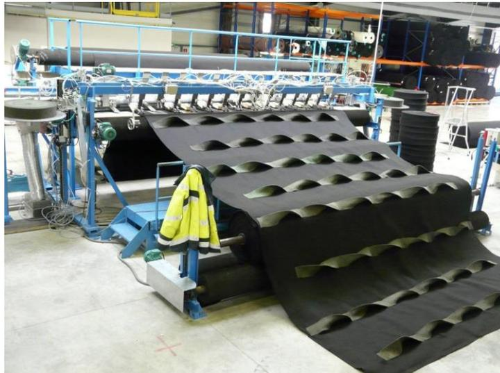
Figure 7. Assemblage en usine du géocomposite
